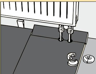
**4** Bei Heizrohrdurchbrüchen die Diele am Stoß aus-klinken und mit Heizkörperprosetten abdecken.
