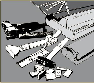
**1** Alles bereit? PE-Folie und Kleband. Als Werkzeug: Zollstock, Bleistift, Stichsäge, Fuchschwanz, Fäustel, Setzlatte, Zügeisen, Schlagholz und Abstandskeile.
